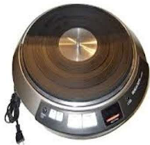
【ターンテーブル】 レコードを回転させる台
