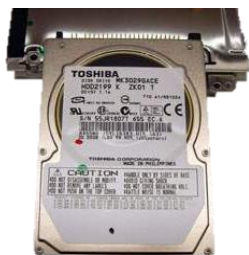
内蔵されるHDDはIDE(ATA) 2.5インチサイズ (写真はCN-HDS935MD内蔵)
