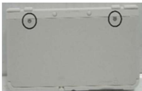
本体裏面のプラスネジを2本外す (上図の写真中の丸印)
