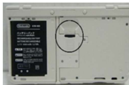
カバーを取り外し、 microSDカードを取り出す (上図の写真中の丸印)
