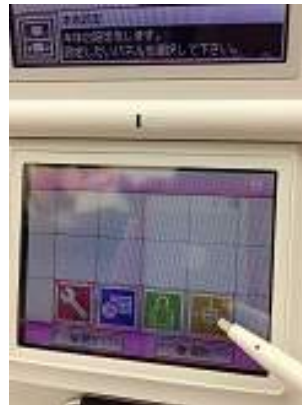
右端のタッチパネルの補正をタッチ
