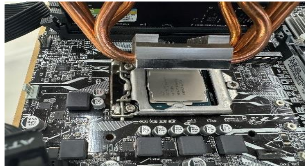
CPUの上にクーラーをのせます。 チェッ クだけならネジで固定する必要はありません
