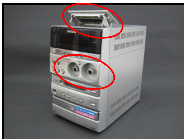
・キーボードが浮いてしまって打てないノートパソコン ・トレーが閉まらない、ツマミが欠品しているミニコンボ
