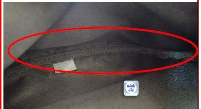
内側の縫製の仕様が異なり、縫製が雑なものも多く確認されている
