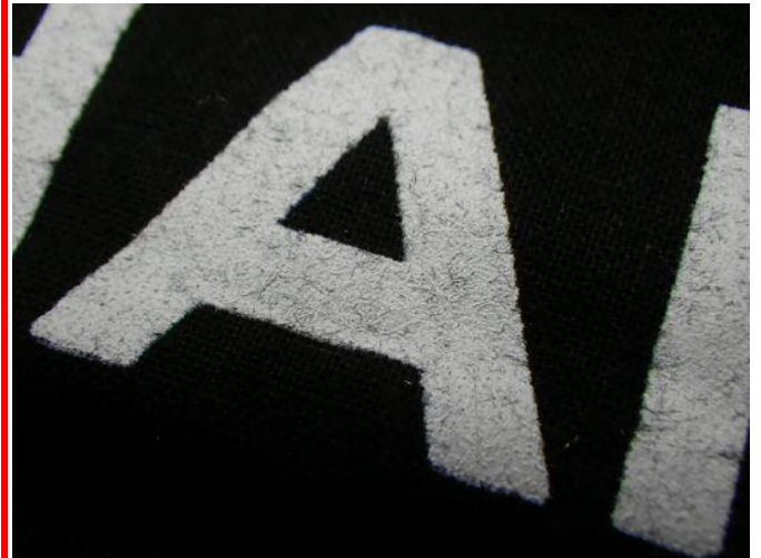
インクが厚く塗られていて 生地繊維が見えないものが 多く確認されている
