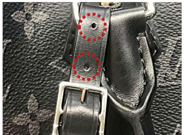
基準外のラゲージタグ ベルトホール 基準内より穴が小さいものが 確認されている
