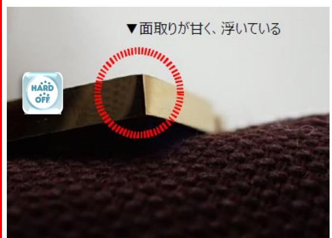
フラップ金具のつくりや取り付けが雑になっているものが確認されている
