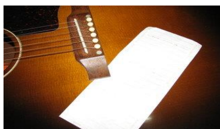
ブリッジ浮き
