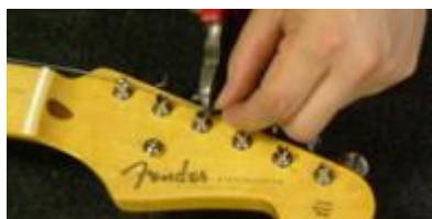
①長さを調整してカットする。
