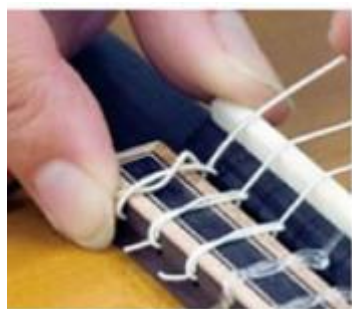
③弦の先端を強く引っ張りしばって固定する
