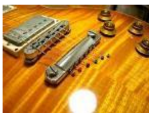
①ストップバーに弦を通す。※逆通しのモデルもあるので注意
