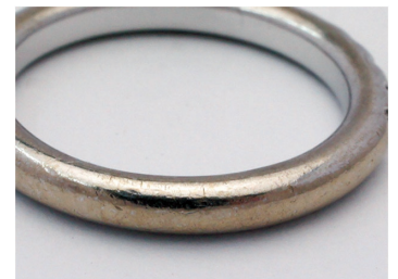
金メッキが剥がれた様子
