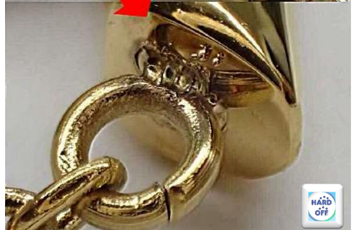
基準外のフック仕上げ 雑な仕上げになっている
