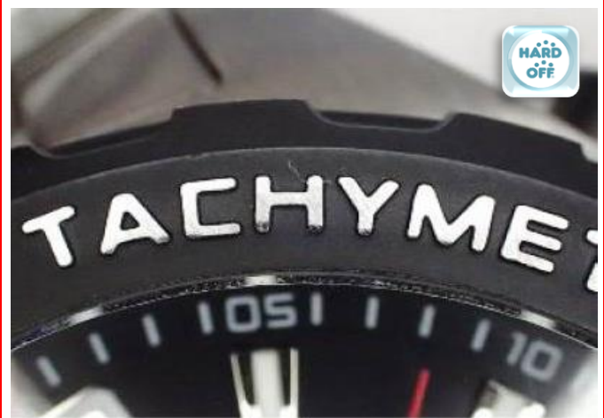
基準外のベゼル文字 基準内と異なる字体のものが 多く確認されている
