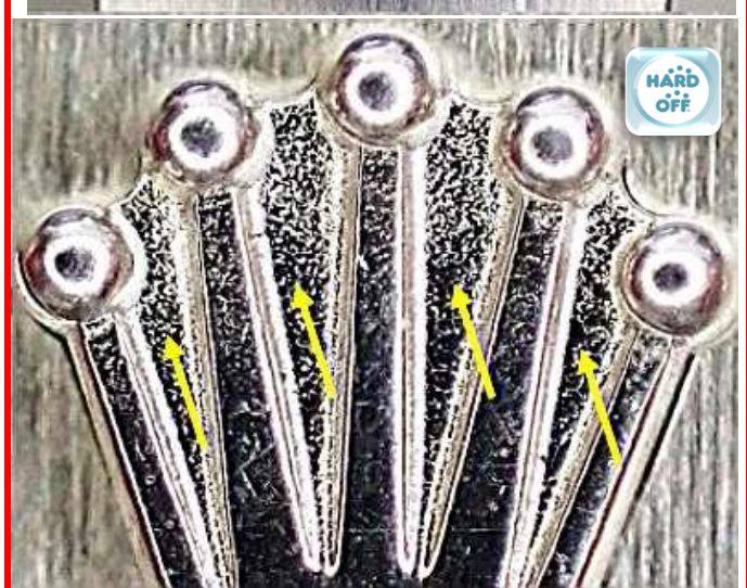
クラスプ王冠マークの間の部分がざらざらしているものが確認されている
