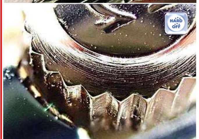
リュウズ表面の仕上げが雑なものが 確認されている
