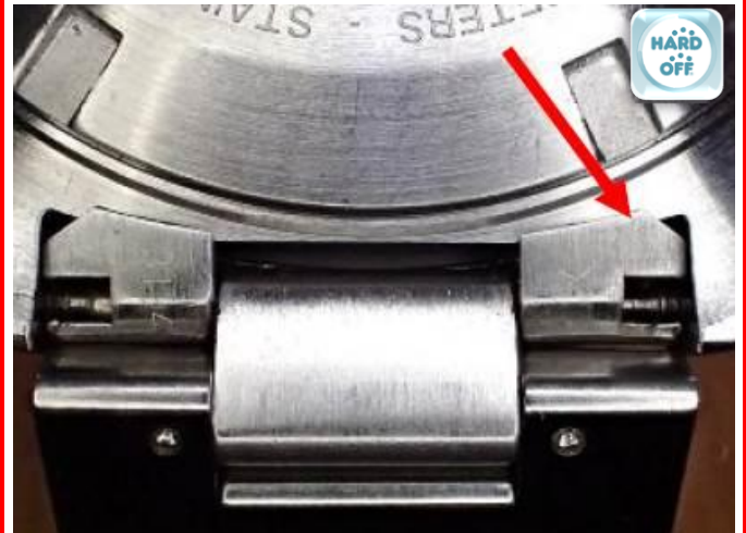
基準外のエンドピース裏側 基準内に比べて角ばっているものが 多く確認されている
