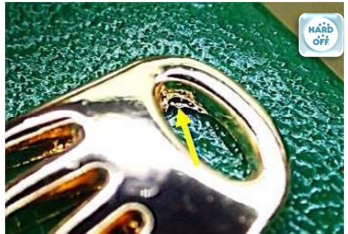
基準外品では矢印の部分にバリが見られるものが確認されている
