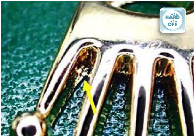
基準外品では矢印の部分にバリが見られるものが確認されている
